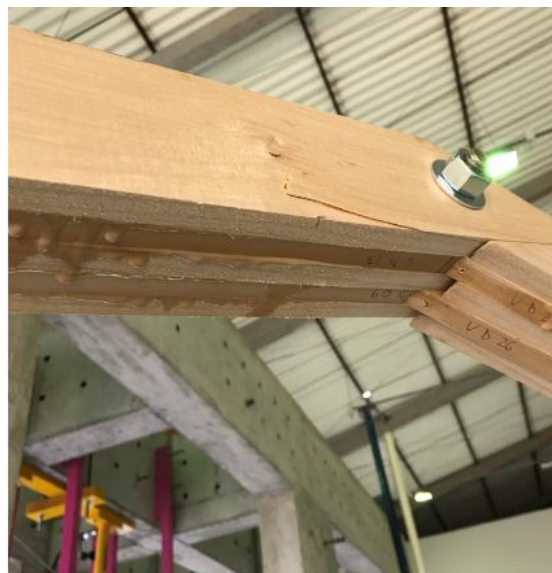
Figura 19 – Detalhes de ruptura do pórtico 2, vista superior do nó C e frontal do nó D, respectivamente.
