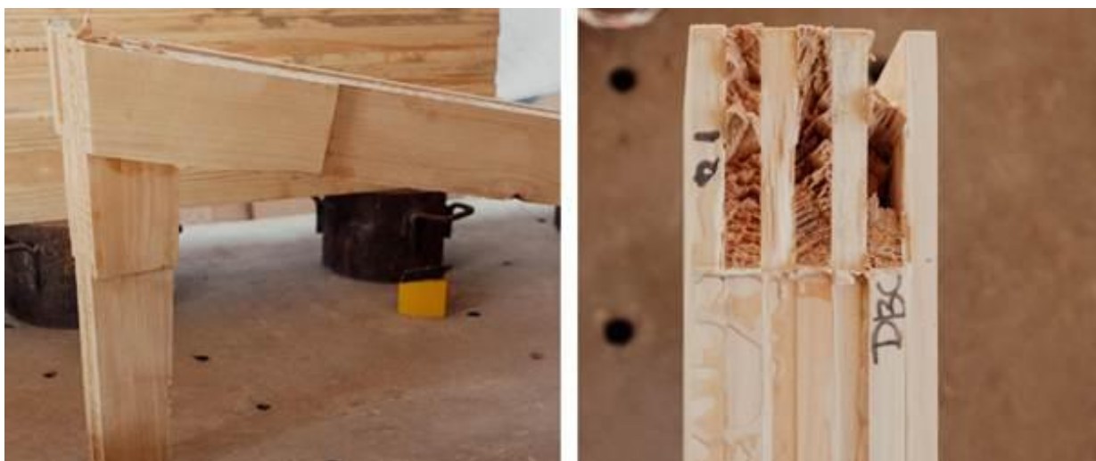
Figura 18 – Detalhes de ruptura do pórtico 1, nó C, vistas lateral e interna.
