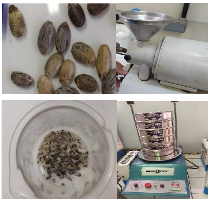
Figura 13. a) Sementes de favela, b) Triturador industrial, c) Massa de sementes de favela pós trituração, d) Equipamento de agitação vertical vibratória utilizado para determinar diâmetro das partículas. Fonte: A autora.
