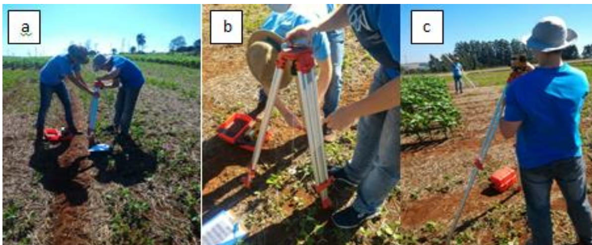
Figura 1 – a) Colocação do tripé no terreno, de modo a instalar o nível; b) verificação do prumo para conferir o nível; c) medição das declividades por meio de leituras de ré e vante com o auxílio da régua.
