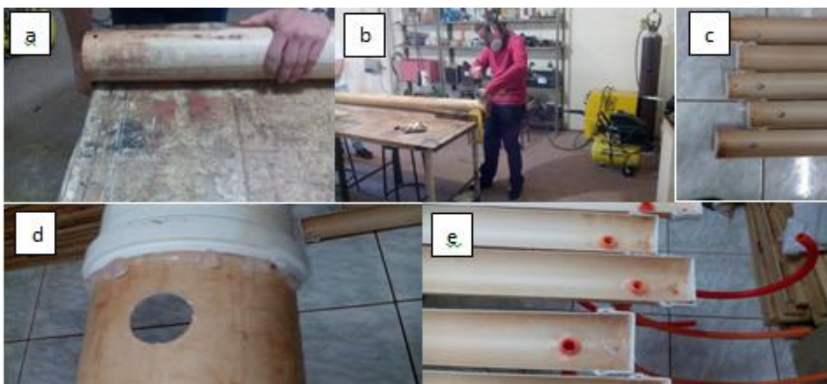
Figura 12 – Calhas confeccionadas, em que: a) marcação para o corte horizontal dos canos de 5 cm de diâmetro por 3 metros de comprimento para posterior corte; b) corte dos canos com a cerra fita, com os EPIs de segurança para a devida atividade; c) furo dos canos para posterior alojamento das mangueiras corrugadas 3/4" de diâmetro; d) colagem das tampas na calha com cola de silicone; e) inserção das mangueiras nas calhas com cola de silicone, permanecendo estagnadas até a secagem.
