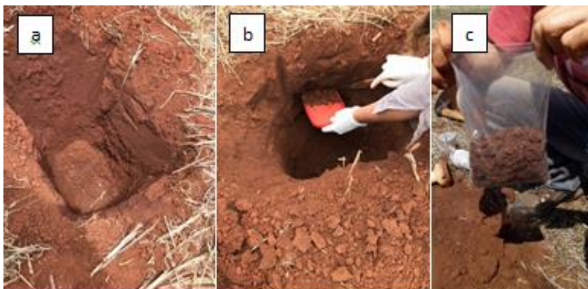
Figura 5 – Coleta das amostras químicas do solo: a) abertura da trincheira, com suas marcações de profundidade; b) retirada das amostras químicas com faca, de acordo com as marcações pré-estabelecidas, c) deposição das amostras químicas retiradas, em recipiente pré-demarcado de acordo com a parcela e profundidade do ponto de coleta.
