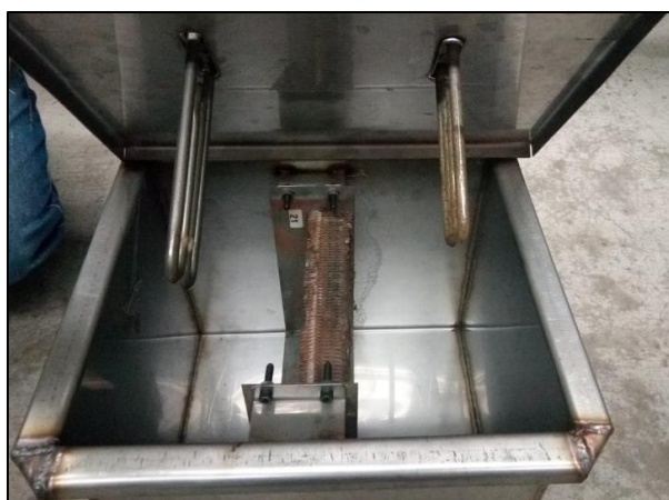
Figura 22. Radiador e resistências inseridos no reservatório. Fonte: Arquivo do autor (2019).
