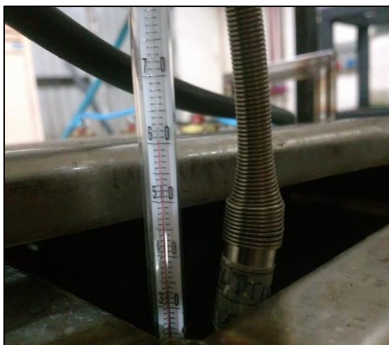
Figura 33. Termômetro e sensor de temperatura no reservatório de água. Fonte: Arquivo do autor (2019).
