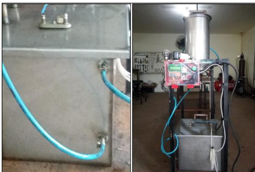
Figura 24. Ligação para deslocamento do combustível conforme circuito. Fonte: Arquivo do autor (2019).
