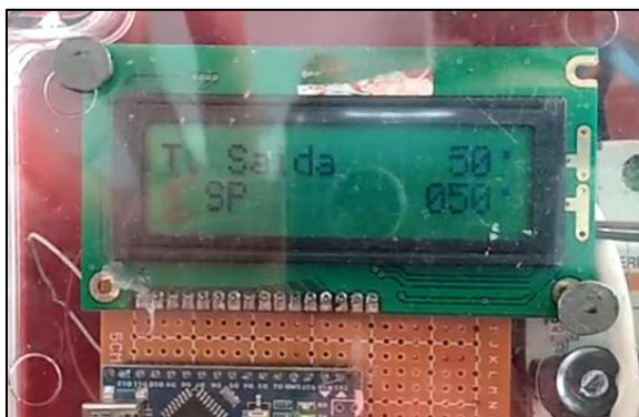
Figura 43. Temperatura final de ensaio com diesel. Fonte: Arquivo do autor (2019).
