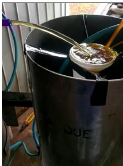
Figura 37. Termômetro inserido no final do circuito de biodiesel. Fonte: Arquivo do autor (2019).
