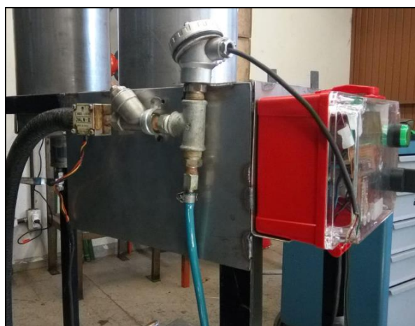
Figura 13. Sensor de medida da temperatura de saída. Fonte: Arquivo do autor (2019).
