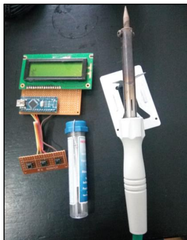
Figura 17. Ferro de solda e material de estanho usado na soldagem dos componentes eletrônicos. Fonte: Arquivo do autor (2019).
