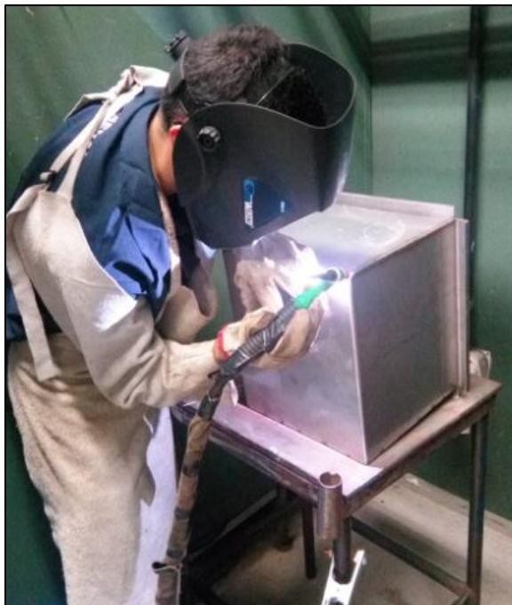
Figura 21. Processo de soldagem TIG no reservatório. Fonte: Arquivo do autor (2019).
