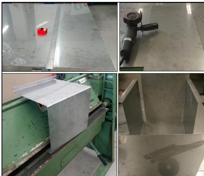
Figura 20. Processo de traçagem corte e dobra do reservatório de água. Fonte: Arquivo do autor (2019).
