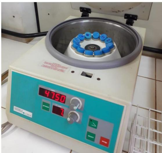
**Figura 4.6:** Centrifuga recebendo o cultivo para iniciar a operação. Fonte: Santos (2019).
