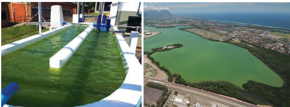
**Figura 3.6:** Ao lado esquerdo, um biorreator do tipo tanque aberto; do lado direito, uma lagoa natural contendo microalgas. Fonte: Borghetti (2009).
