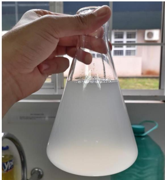
**Figura 3.3:** Manipueira, resíduo líquido do processamento da fécula. Fonte: Santos (2019).
