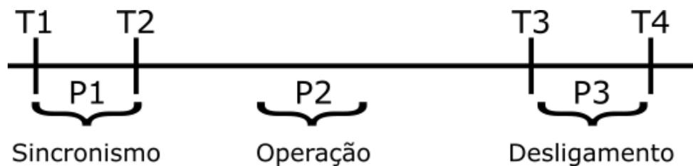
**Figura 2.4:** Fases de operação de um gerador diesel.
