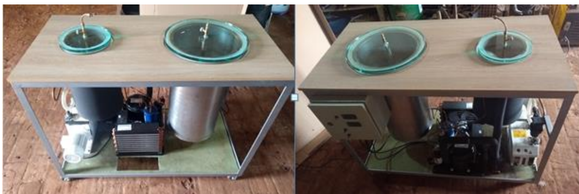
Figura 9 – Foto do protótipo de liofilizador desenvolvido na pesquisa Fonte: o autor.
