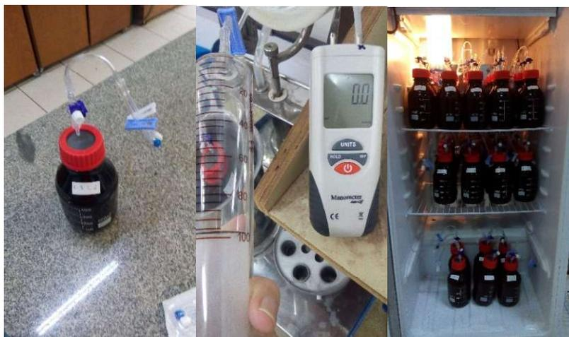
Figura 7 Reator para o ensaio do potencial de produção de biogás.
