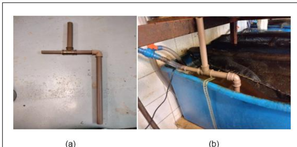
Figura 9 - Aerador montado (a) e Aerador implantado e em funcionamento (b).
