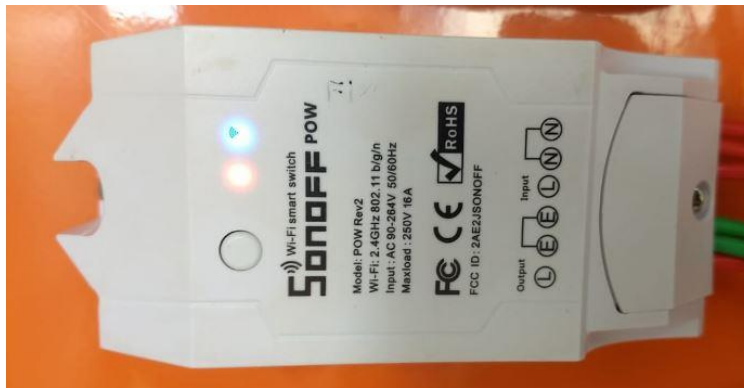
Figura 20 – Medidor de Energia, fabricante ITEAD SONOFF, modelo POW R2.
