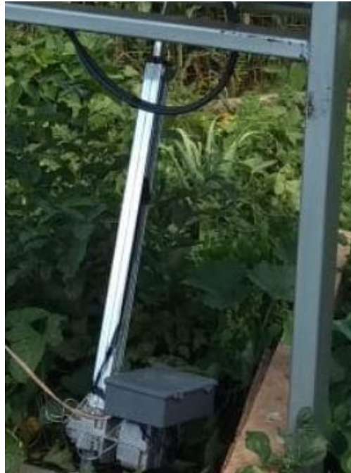
Figura 40 – Motor monofásico com caixa de redução de 1:23 acoplado ao fuso trapezoidal.
