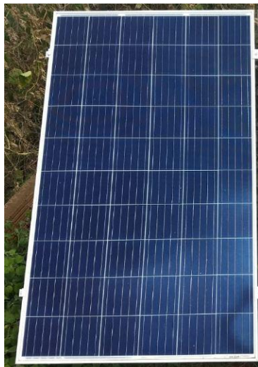
Figura 18 – Painel Solar GCL SOLAR, modelo GCL-P6/60275, potência 275W.
