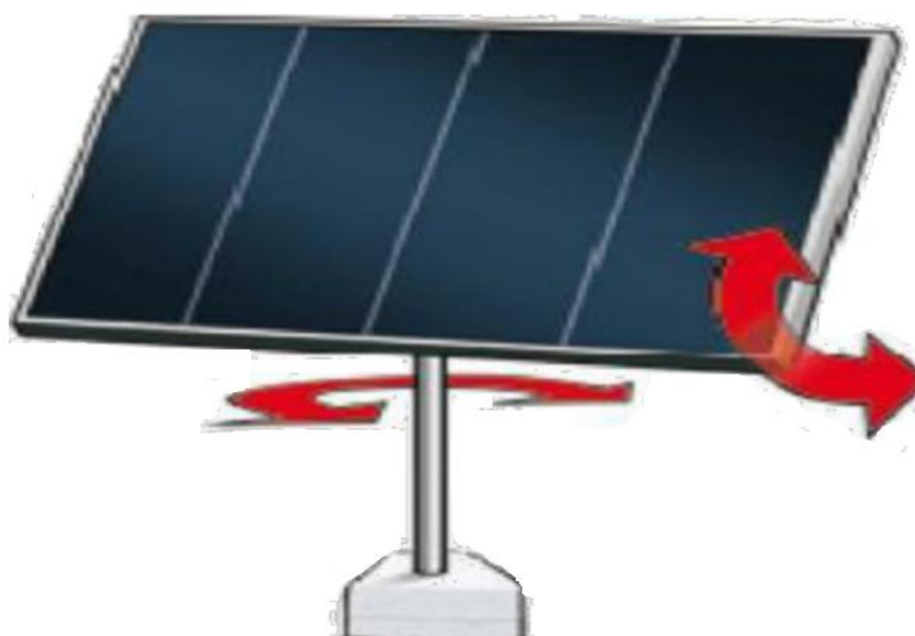
Figura 14 - Sistema de Rastreamento solar de dois eixos. Fonte: ZAKARIAH et al , (2015)
