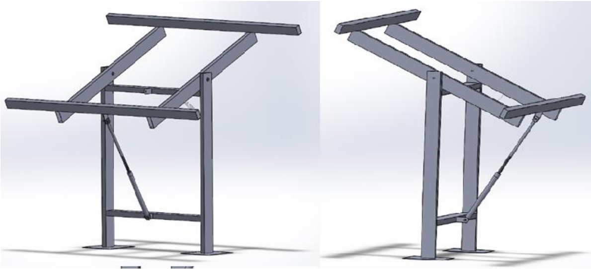
Figura 38 - Protótipo para Sistema Fotovoltaico de Um Eixo
