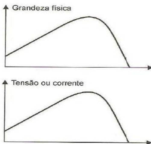
Figura 4 – Exemplo de resposta de um sensor com saída analógica. FONTE: Thomazini e Albuquerque (2012).
