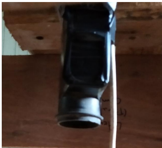
Figura 15 – Canal de escoamento do fertilizante colocado na parte inferior da estrutura de ensaios.
