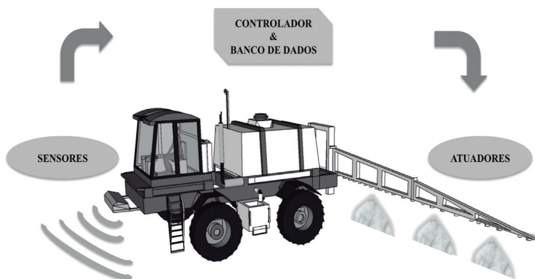
Figura 11 – Exemplo de sistema de sensoriamento com a utilização de dispositivos On-The-Go em máquinas agrícolas FONTE: Sousa et al. (2014).
