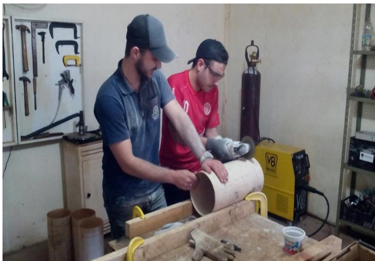
Figura 1: Corte dos tubos de PVC.
