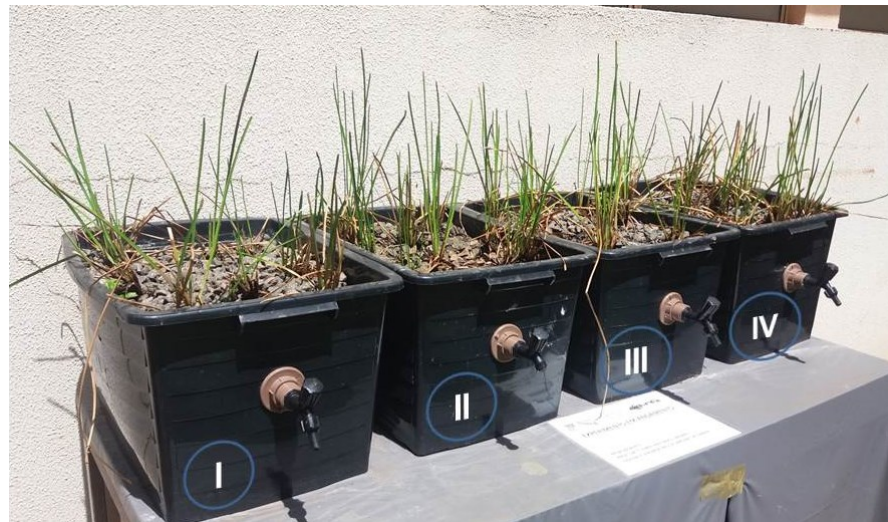
Figura 11: Imagem dos sistemas de wetlands construídos no início do replantio das mudas. Protótipos PI e PII: substrato terra diatomácea e brita; Protótipos PIII e PIV: areia de filtro e brita.
