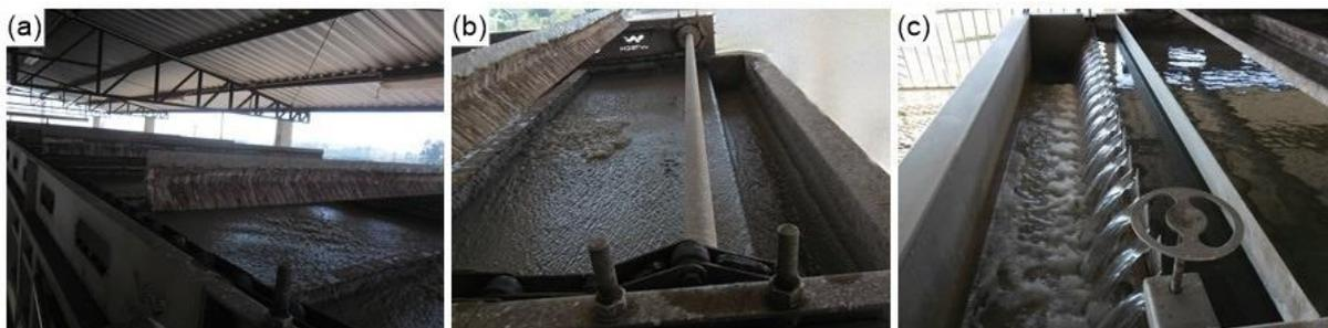
Figura 3 – Geração do lodo terciário de laticínio: (a) flotor físico-químico, (b) remoção do material flotado por raspadores automáticos e (c) saída do efluente tratado, após a remoção do lodo
