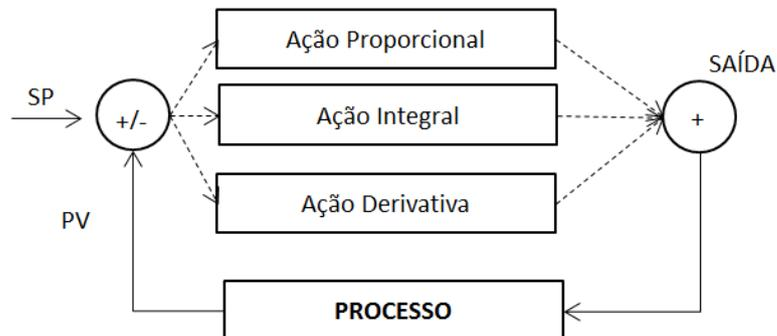
Figura 23- Diagrama que demonstra a estrutura do controlador PID implementado
