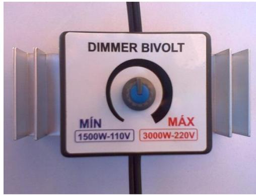
Figura 24- Dimmer controlador de potência para alterar a tensão da resistência elétrica
