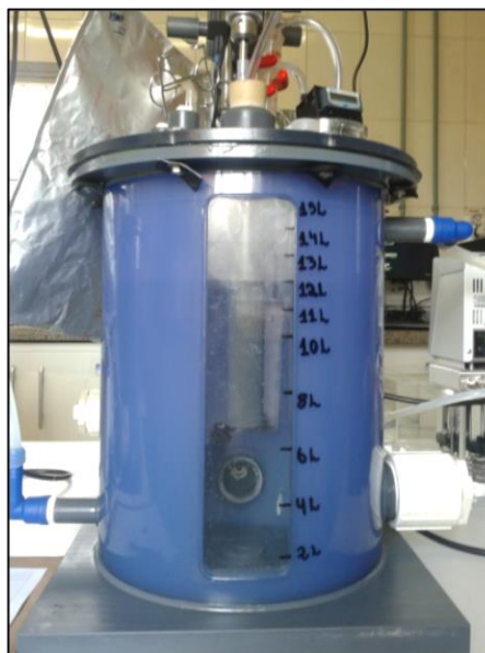
Figura 3 Reator CSTR utilizado para avaliar as duas formas de partida do reator.
