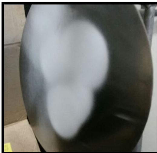
Figura 3.3: Anteparo coletor metálico com deposição da membrana polimérica em diferentes pontos ao longo do processo de eletrofiação.
