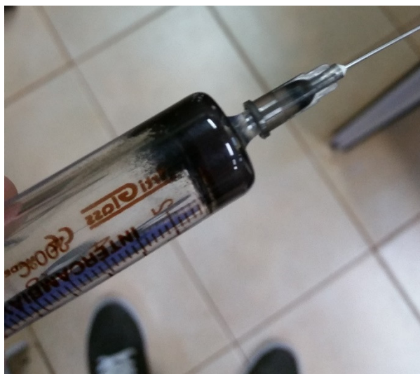
Figura 3.2: Presença de precipitado da liga semicondutora entre o êmbolo e parede da seringa.
