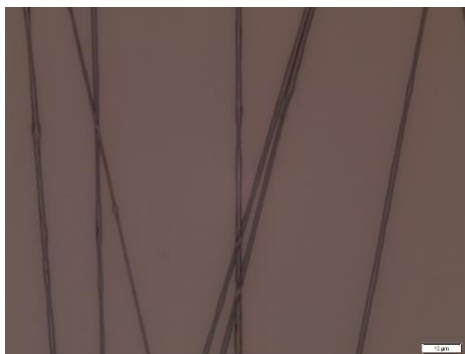
Figura 8 - Imagem das fibras produzidas no experimento 17 com fluxo de 0,5 \text{ mL}\cdot\text{h}^{-1} , 15 kV, 12 cm, dimetilformamida/clorofórmio (15:85), 15% ecovio®, 0,5% (m/m) nitrofurazona em relação ao ecovio®.
