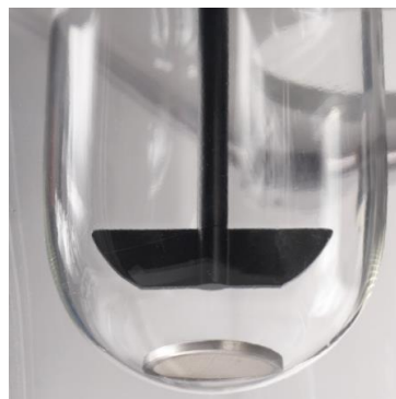
Figura 5 - Aparato 5 - pá sobre disco. [62]
