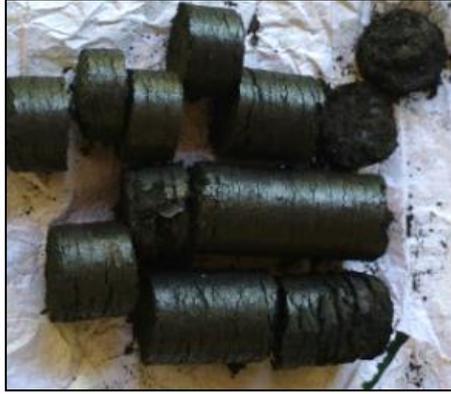
Figura 4.5 - Briquetes após a imersão em óleo vegetal residual a 160 °C.
