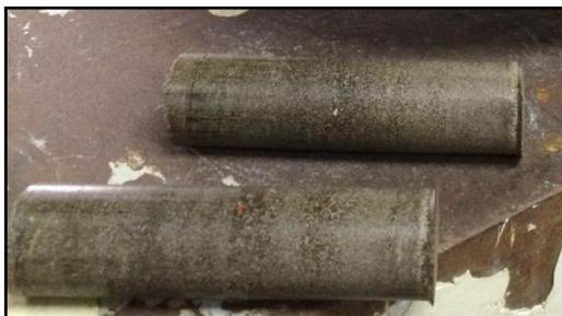
Figura 4.3 - Fotografia ilustrativa dos briquetes que apresentaram maior resistência mecânica (briquete-1, 100% lodo e 0% finos de carvão, 7,5% de aglutinante e 0% umidade).
