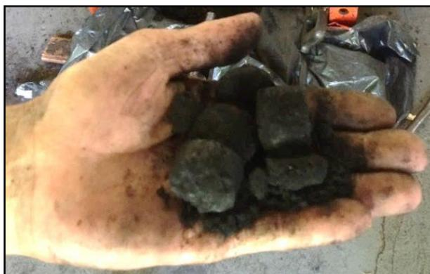
Figura 4.2 - Briquetes que não atingiram a resistência mecânica mínima de formação.
