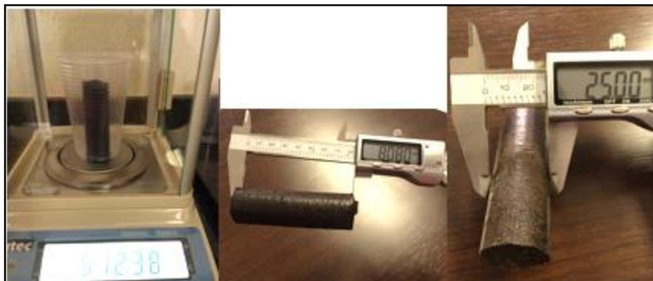
Figura 4.28 - Materiais utilizados para determinar a densidade aparente.
