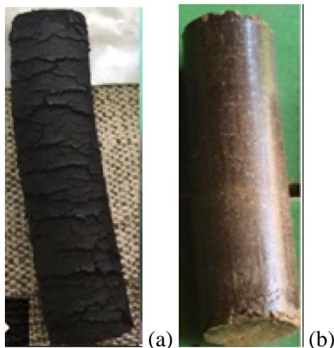
Figura 4.4 - Briquetes de finos de carvão vegetal (a) e lodo de esgoto sanitário (b).
