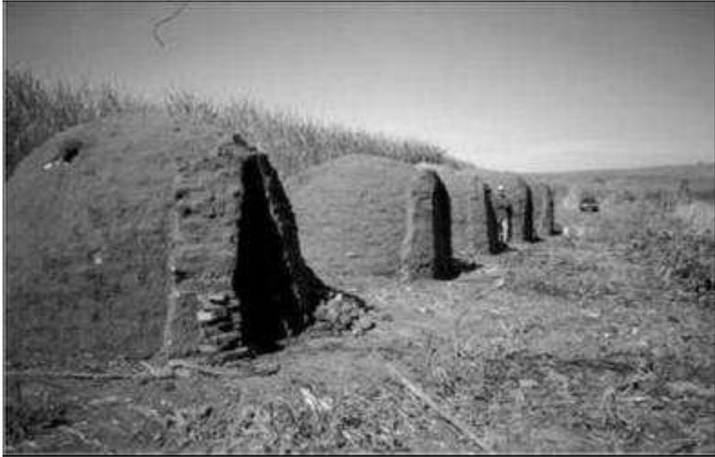
Figura 2.2 - Forno do tipo Rabo – Quente utilizado na produção de carvão.
