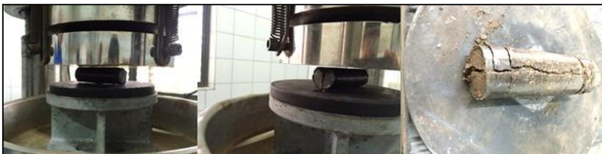
Figura 4.29 - Equipamento utilizado para determinar a resistência dos briquetes.
