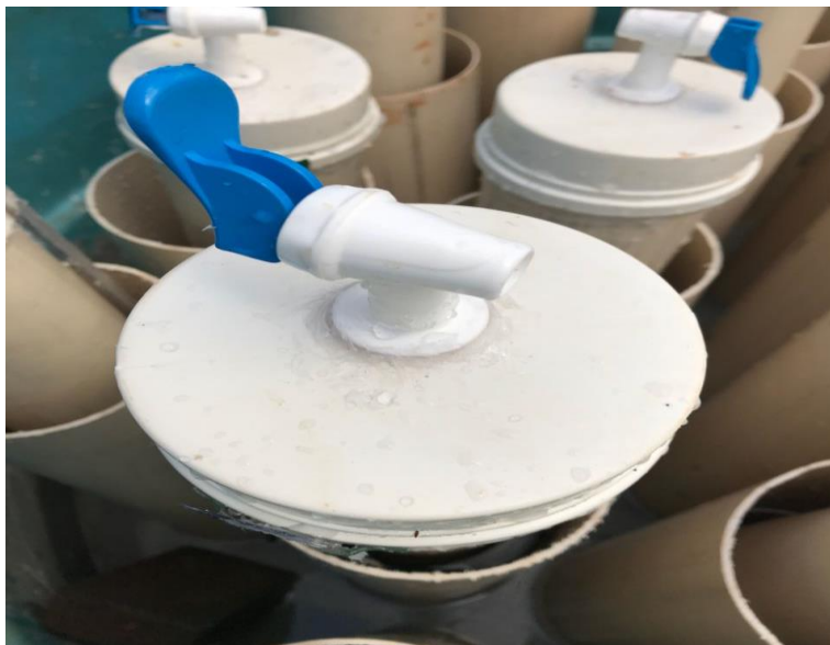
Figura 7 - Válvula para liberação do gás produzido
