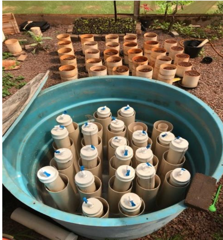
Figura 5 - Caixa d'água com os 24 biodigestores
