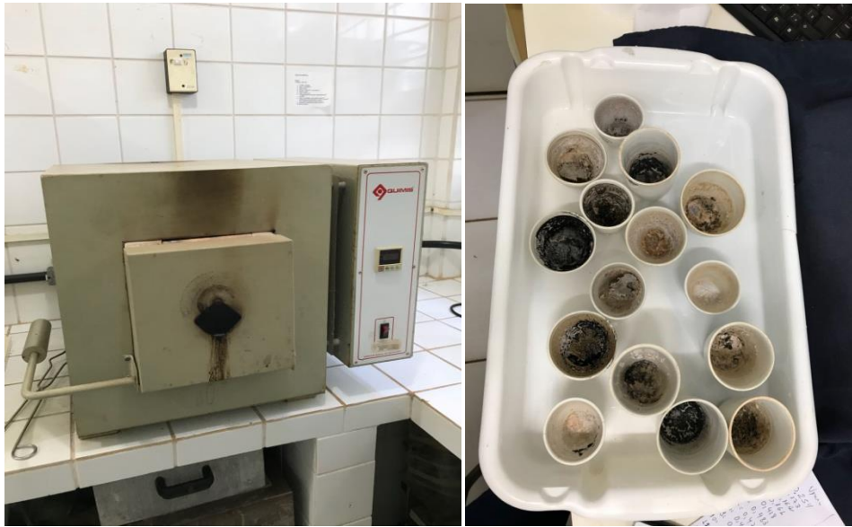
Figura 10 - Mufla e cadinhos com a amostra pronta para pesagem
