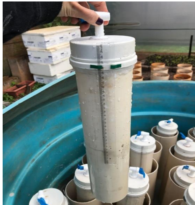
Figura 6 - Tubo de 100mm com a régua medidora presa
