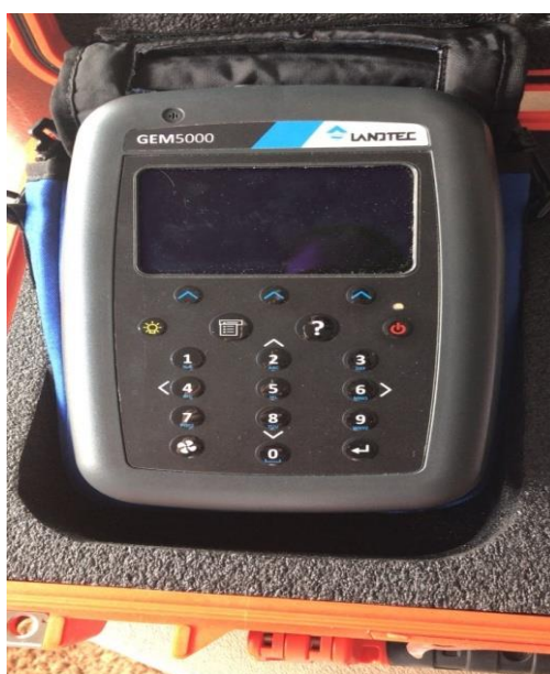
Figura 12 - Aparelho GEM 5000 - LANDTEC
