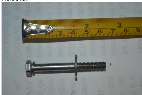
**Figura 53:** Parafuso fixa o do eixo escova.
