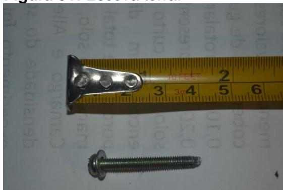
**Figura 52:** Parafusos uni o placa a nacele.
