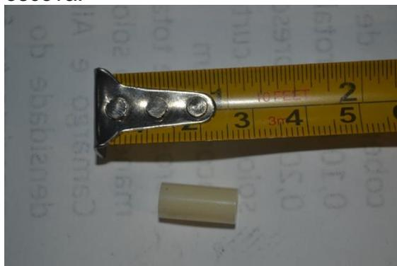
**Figura 54:** Apoio mancal para fixa o da placa
