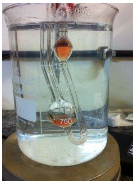
Figura 19 - Viscosímetro Cannon-Fenske utilizado para medição da viscosidade das amostras, em banho maria.
