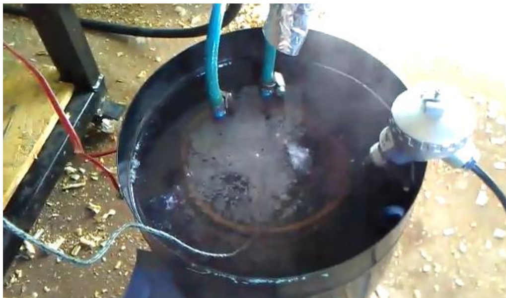
Figura 17 – Recipiente de metal com a serpentina em aquecimento, utilizado no sistema de aquecimento dos biocombustíveis.
