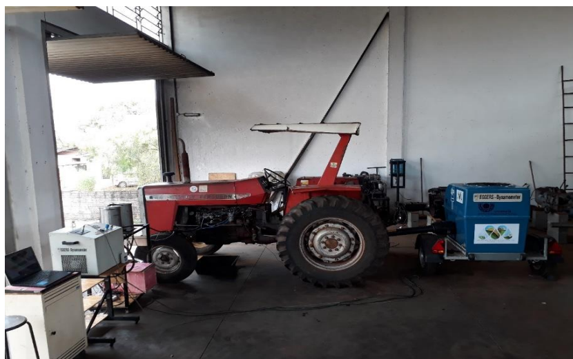
Figura 10 – Trator MF 265 acoplado no dinamômetro via eixo cardã numa ocasião de ensaio.
