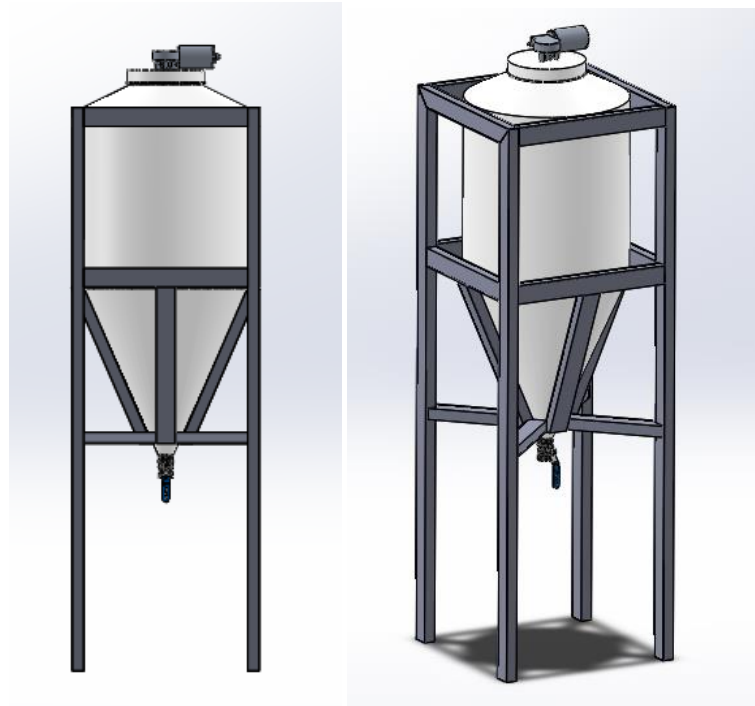
Figura 3 Projeto do Reator de Biodiesel
