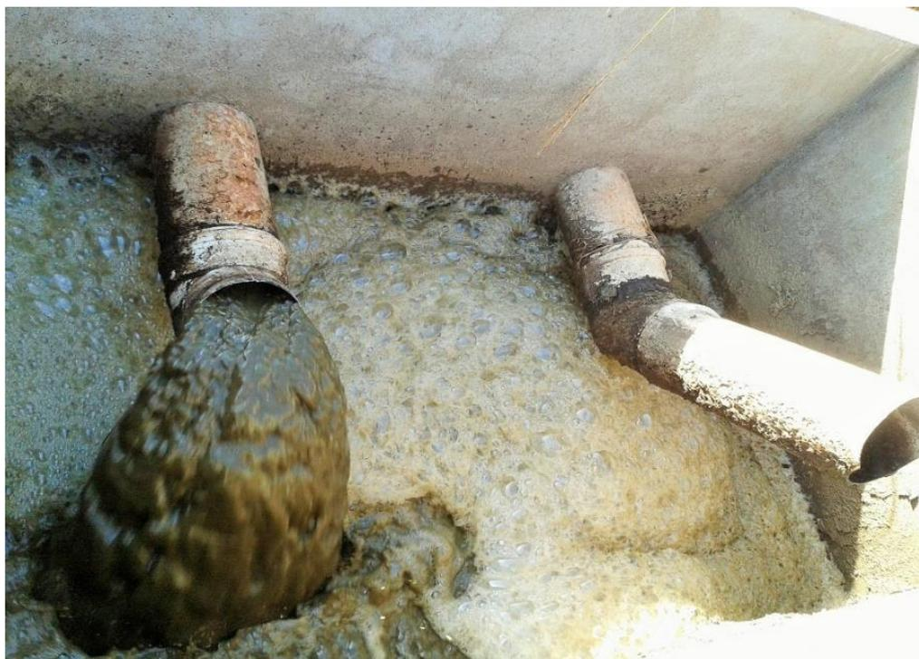
Figura 5 Biofertilizante utilizado para inocular microrganismos anaeróbios nos reatores.
