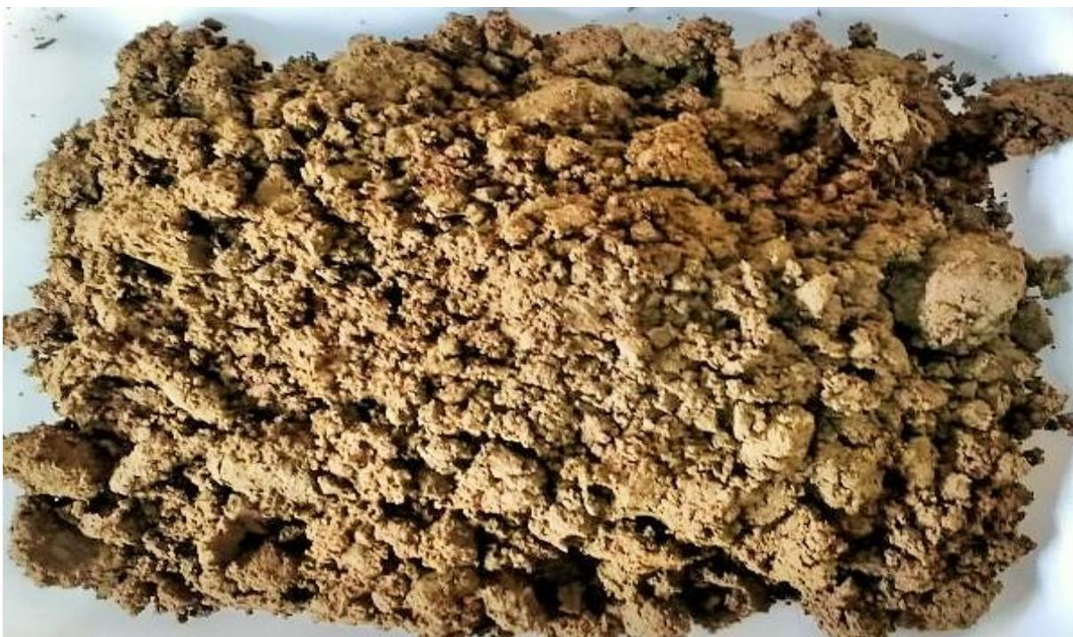
Figura 3 Lodo de flotor proveniente da linha vermelha de abatedouro de aves.
