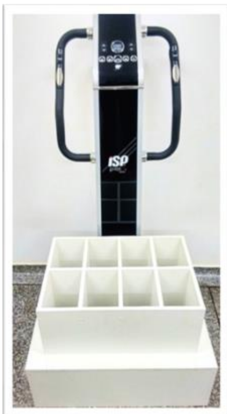
Figura 1 - Plataforma Vibro Oscilatória Arktus triplanar profissional com suporte para separar os animais por baias. Fonte: autora.
