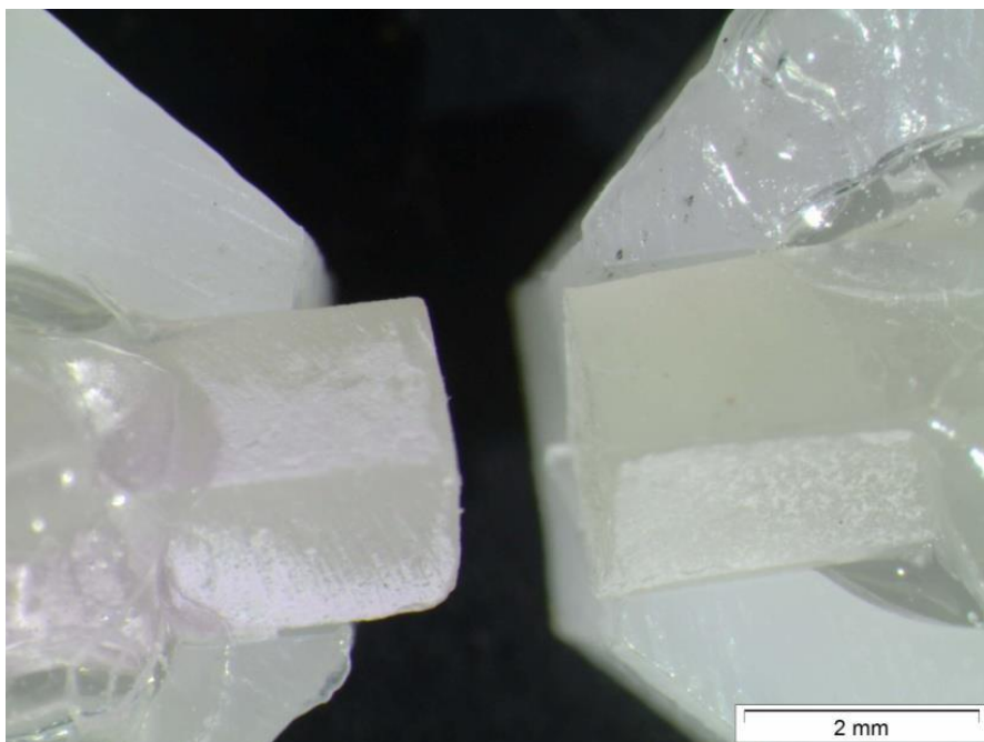
Foto 1: Fotografia realizada com câmera de captura SC30 acoplada ao estereomicroscópio óptico trinocular Olympus SZX7, da fratura tipo adesiva.
