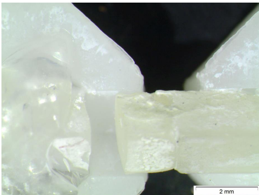
Foto 2: Fotografia realizada com câmera de captura SC30 acoplada ao estereomicroscópio óptico trinocular Olympus SZX7, da fratura tipo coesiva.
