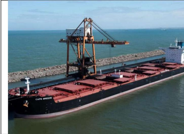
Navio do tipo VLOC – Very Large Ore Carrier para carregamentos acima de 200 mil toneladas.
