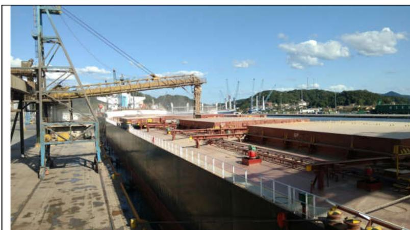
Carregamentos de granéis sólidos no Porto de São Francisco do Sul, em navio do tipo Handymax, com correias transportadoras ou dagas e guindastes *shiploader*.
