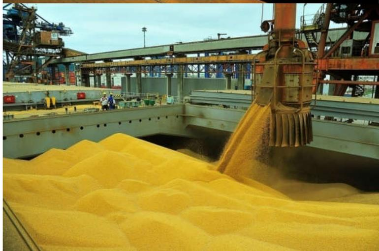
Carregamentos de granéis sólidos no Porto de Paranaguá, em navio do tipo Handymax (40 a 60 mil toneladas), com correias transportadoras ou dagas e guindastes *shiploader*.
