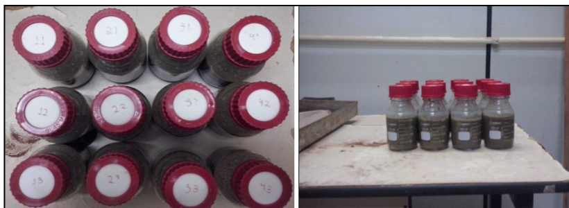
FIGURA 12: BIODIGESTORES BATELADA. Fonte: Arquivo pessoal.
