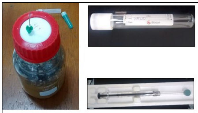
FIGURA 20: PROCESSO DE REMOÇÃO DO BIOGÁS COM SERINGA. Fonte: Arquivo Pessoal.
