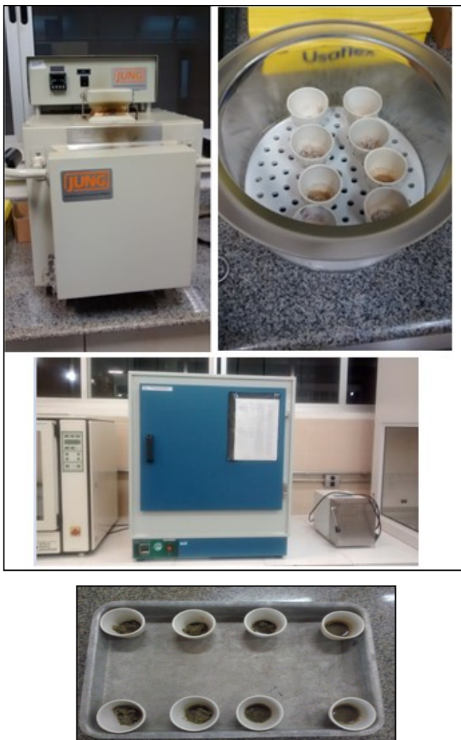
FIGURA 21: AMOSTRAS PARA ENSAIO DE SÉRIE DE SÓLIDOS E EQUIPAMENTOS UTILIZADOS. Fonte: Arquivo pessoal.
