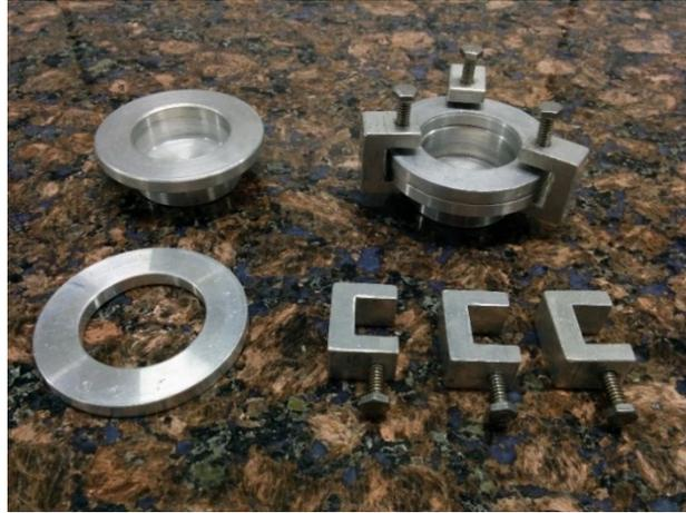
**Figura 3:** Cúpula de Permeabilidade utilizadas para estudo de transmissão de vapor de água.
