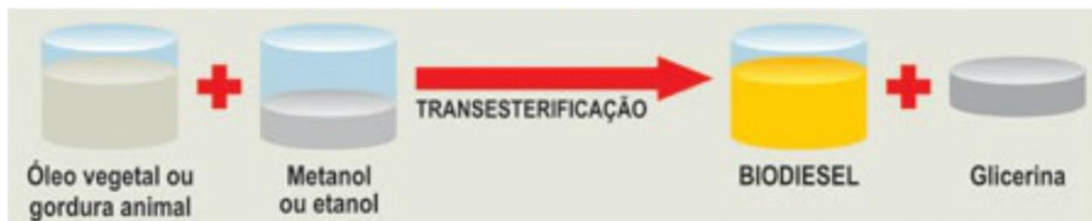
Figura 16. Processo de transesterificação
