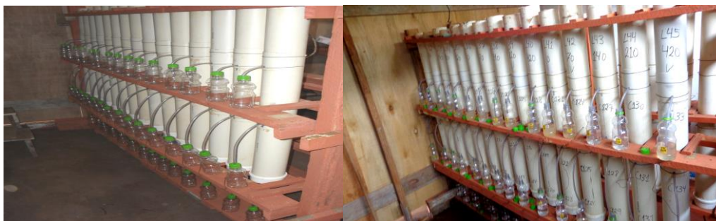
Figura 2: Lisímetros de coluna construídos para o estudo experimental
