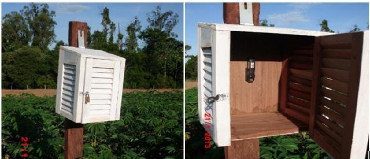
**Figura 1** - Ambiente protegido para abrigo do Datalogger para mensurações de temperatura e umidade relativa do ar.
