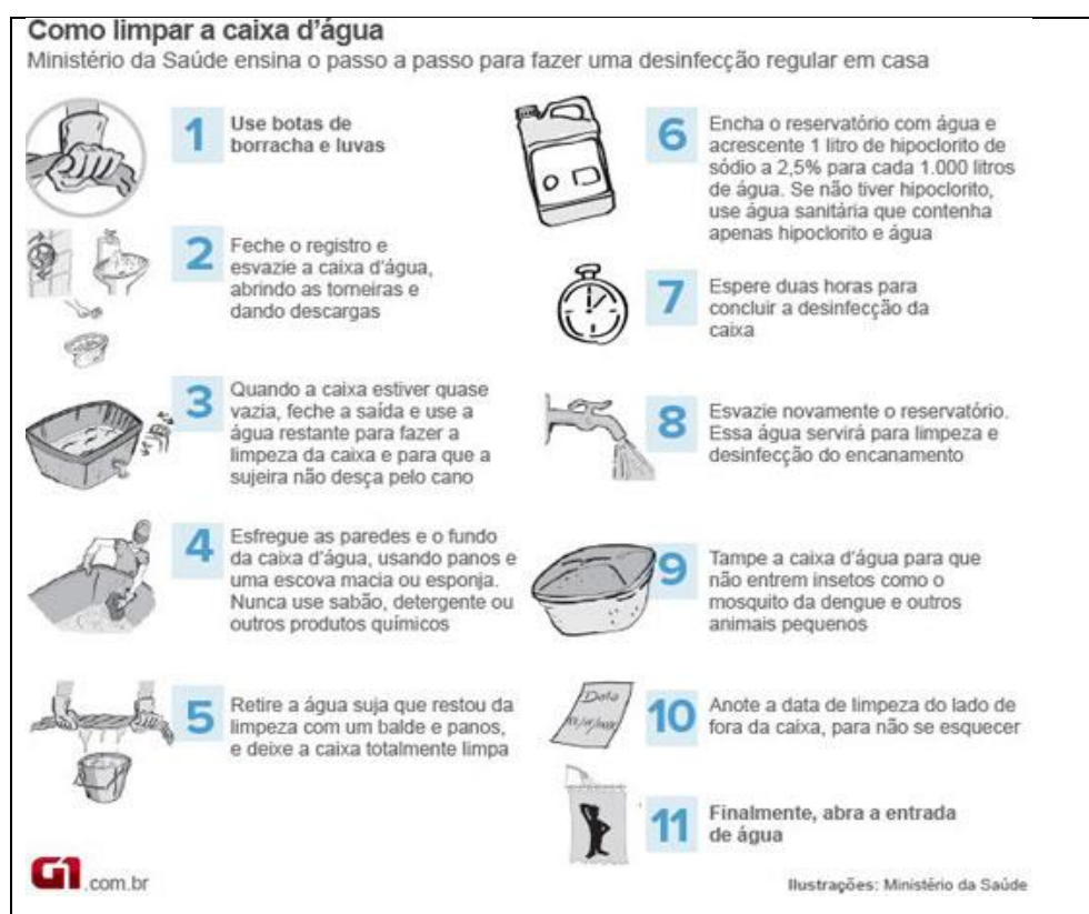
Figura 5 - Procedimentos para Sanitizar o reservatório de água
