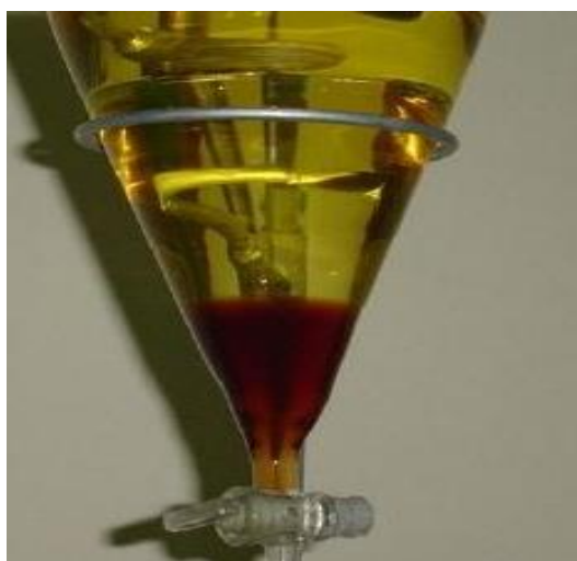
Figura 3 Separação de fases após reação de transesterificação para produção de biodiesel.
