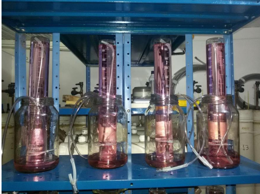
Figura 28 Gasômetros no início da operação e/ou quando zerados.
