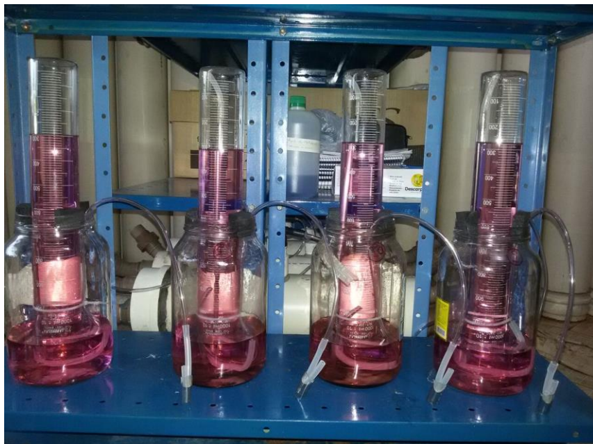
Figura 29 Gasômetros com 36h de operação, quando todos os reatores estavam sendo adaptados, ou seja, todos adicionados com SV 2%.
