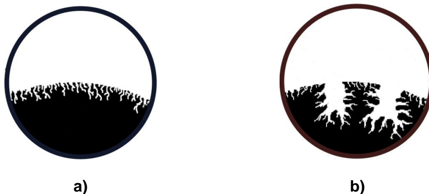
Figura 2. Estrutura a) microporosa e b) micro-mesoporosa de carvão ativado. Fonte: Adaptado de Diez et al. (2014).
