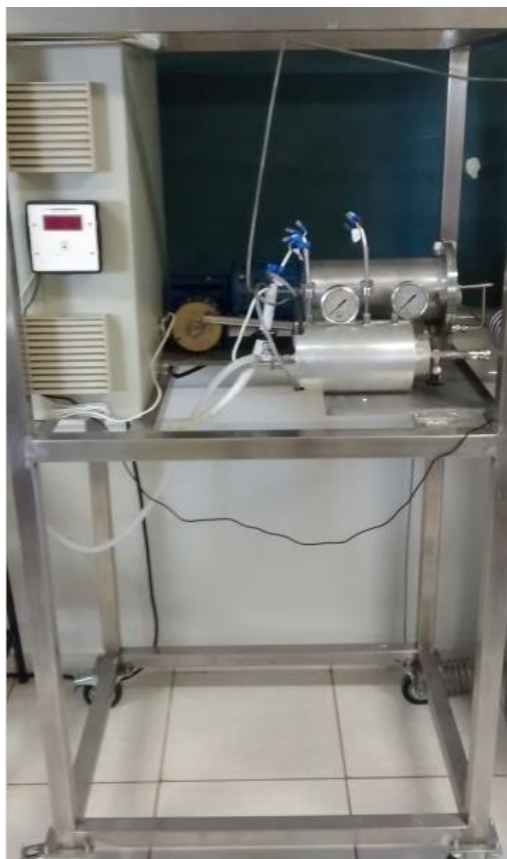
Figura 5. Sistema de armazenamento de gases.
