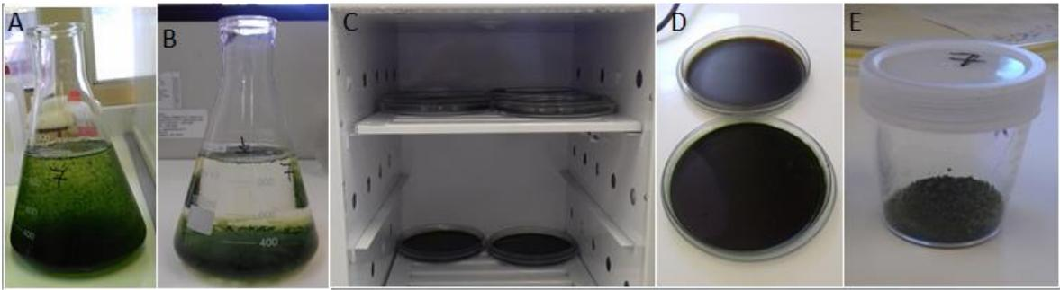
Figura 23 – Recuperação da biomassa do cultivo III. A – Início coagulação; B – Coagulação finalizada; C – Biomassa disposta em placas de petri no interior da estufa; D – biomassa seca; E – Biomassa triturada no recipiente coletor (elaborada pelo autor).
