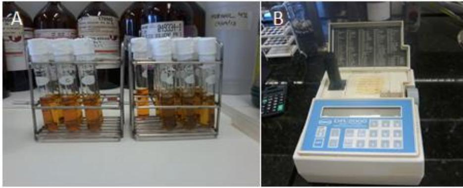
Figura 18 – Análise de DQO. A – Tubos contendo amostra após passar pela estufa; B – Leitura de uma amostra no espectrofotômetro (elaborada pelo autor).
