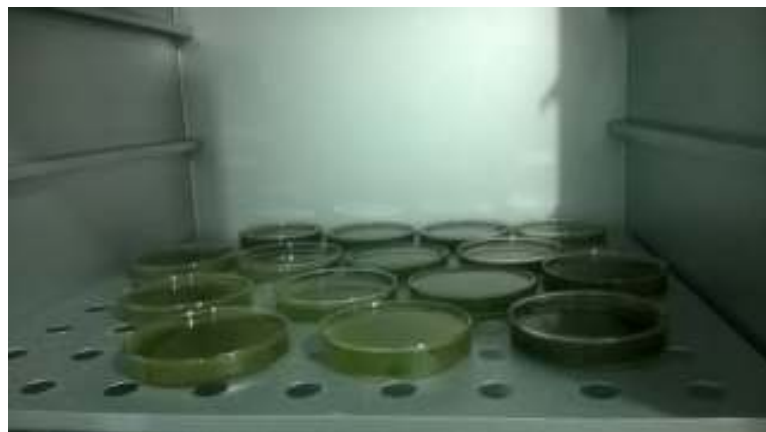
Figura 8 - Secagem em estufa a 60 °C Fonte: Autor, (2016)
