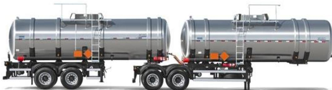
**Figura 12: Bitrem para Transporte de Cargas Líquidas Inflamáveis (2 Reboques)**
