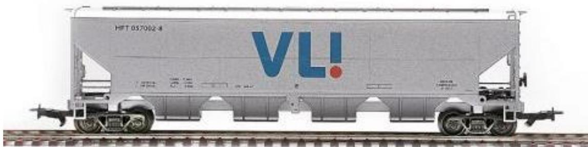
**Figura 16: Vagão Hopper para Transporte de Grãos**
