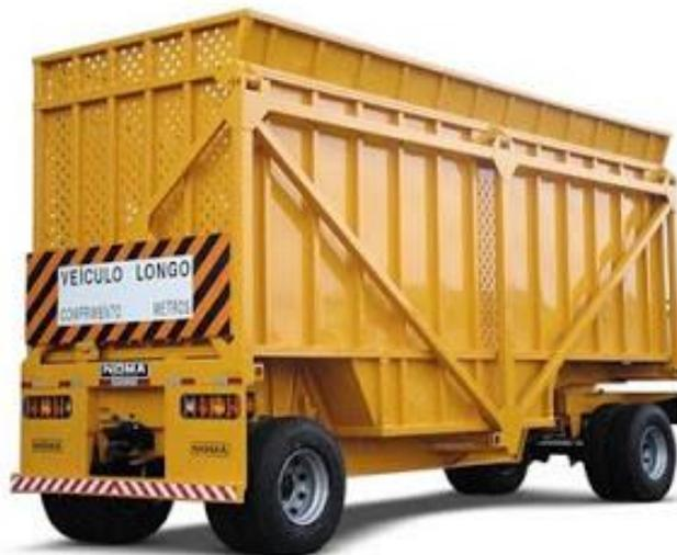
**Figura 14: Reboque Tipo Romeu e Julieta para Transporte de Cana-de-açúcar**
