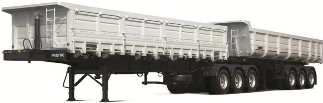
**Figura 15: Exemplo de Bitrem Para Transporte de Grãos**
