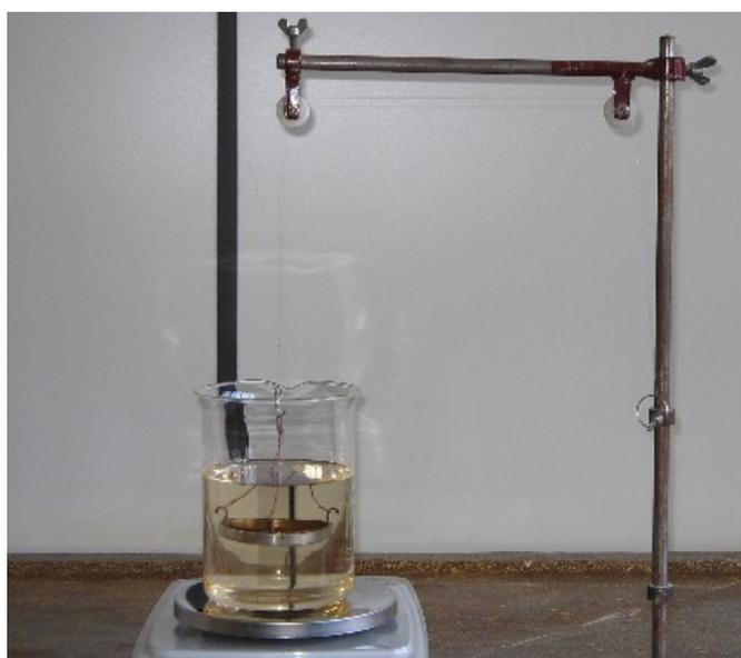
**Figura 01** Sistema para determinação dos pesos hidrostáticos dos agregados P 1.
