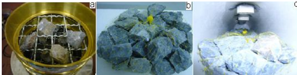
Figura 2 Processo de padronização das pedras de calcário (Figura 2a), acondicionamento em redes (Figura 2b) e no interior do reator (Figura 2c).
