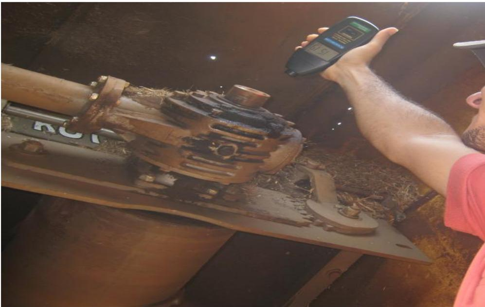
**Figura 5** Tacômetro digital, utilizado para conferência das rotações.
