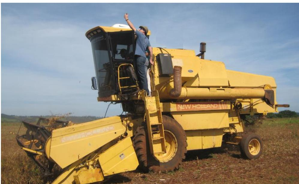
**Figura 6** GPS de “pulso”, para conferência da velocidade de deslocamento.
