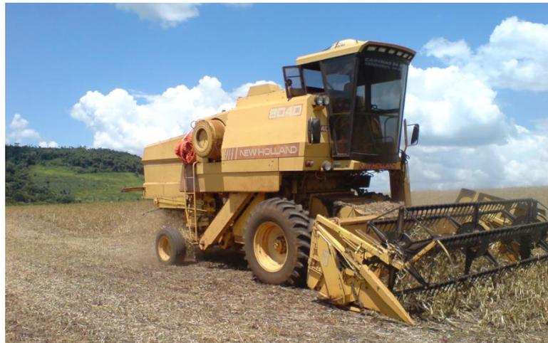
**Figura 3** Colhedora automotriz New Holland 8040 + “kit feijão” e cilindro axial.
