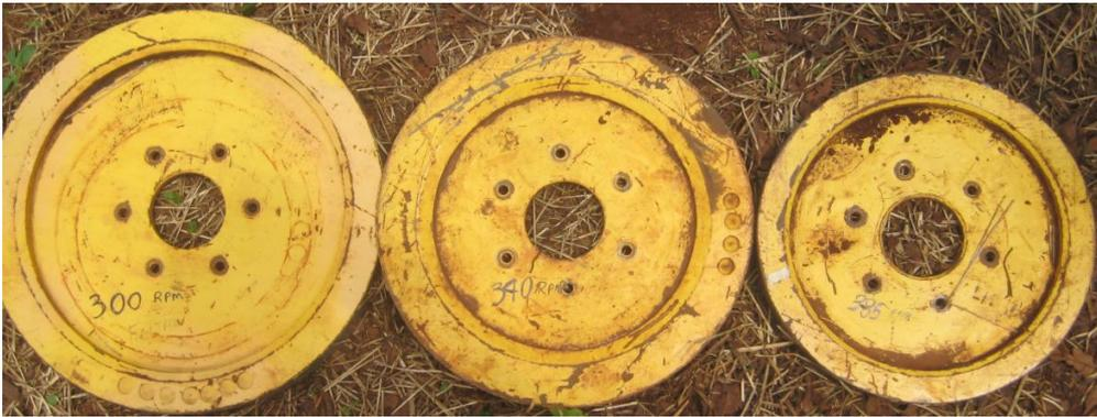
**Figura 4** Polias utilizadas para mudança das rotações (300, 340 e 385 rpm).
