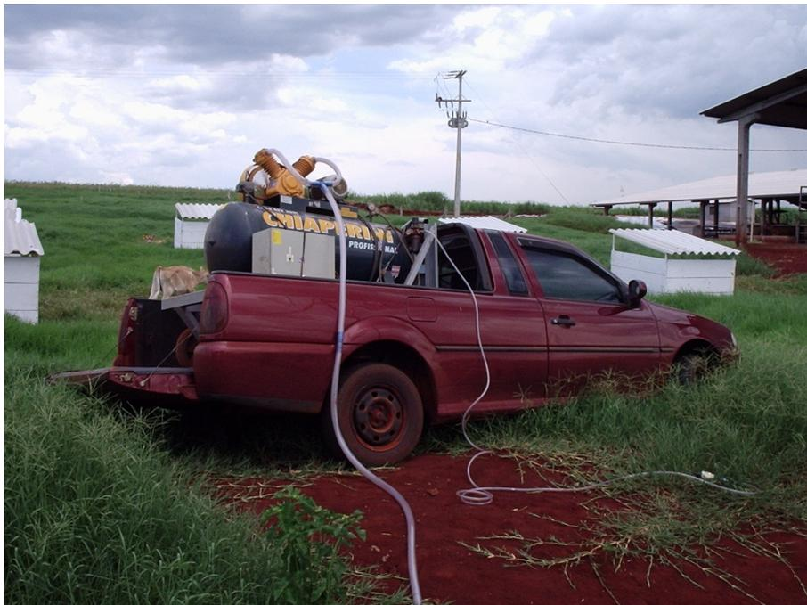
**Figura 8** - Abastecimento do compressor de ar com biogás.
