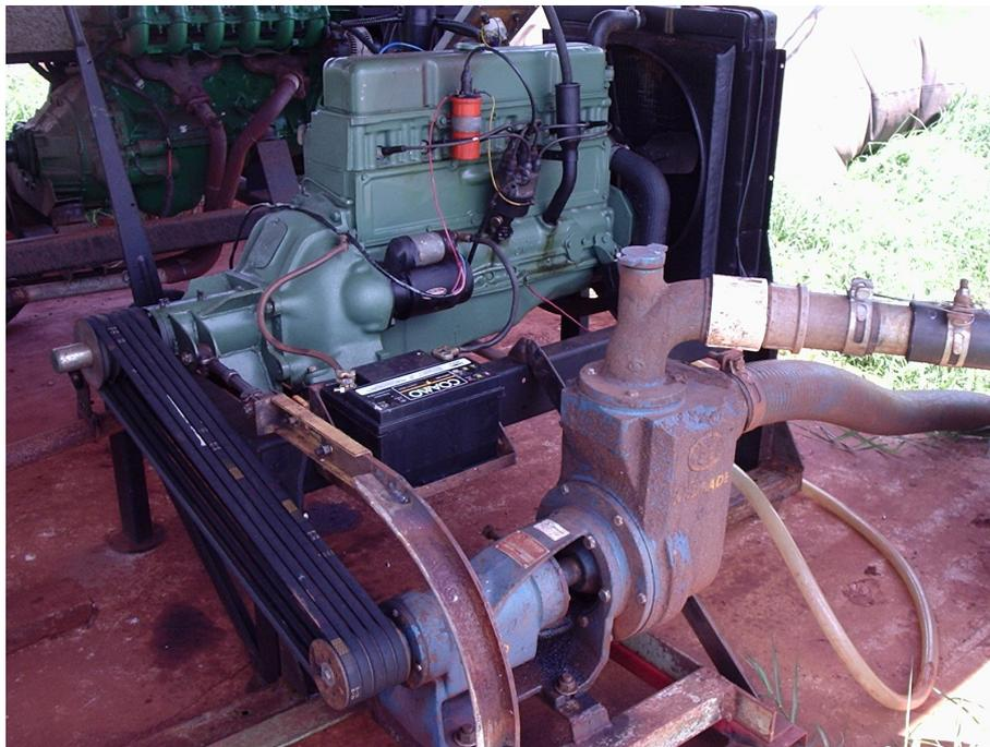
**Figura 6 -** Conjunto motor-bomba utilizado para irrigação na propriedade 1, operando com biogás da bovinocultura.
