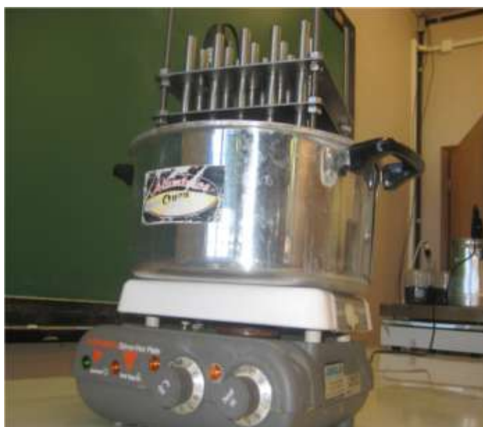
Figura 08 Procedimento para determinação do tempo médio de cozimento – Cozedor de Mattson Adaptado.
