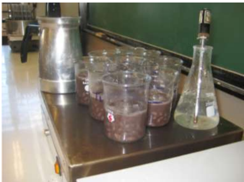
Figura 07 Experimento para determinação da embebição de água antes do cozimento
