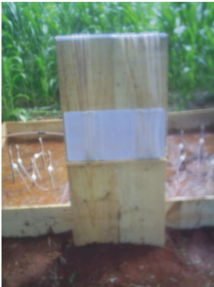
**Figura 3.3** Vista da área do experimento com as três baterias de tensiômetros e as colunas de mercúrio.
