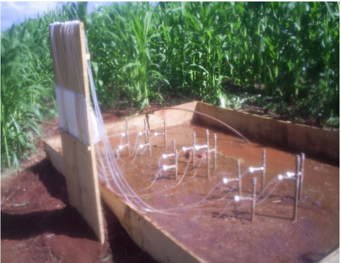
**Figura 3.2** Vista da estrutura do experimento com as três baterias de tensiômetros.
