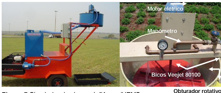
Figura 7 Simulador de chuvas InfiAsper/UFMS. Fonte: Dal Bosco (2007).
