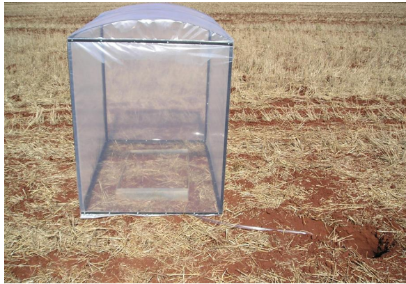
Figura 6 Mini-estufa, calha e mangueira para coleta do escoamento. Fonte: Dal Bosco (2007).
