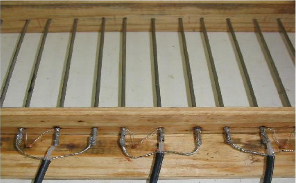
**Figura 2** - Estrutura das sondas de TDR.
