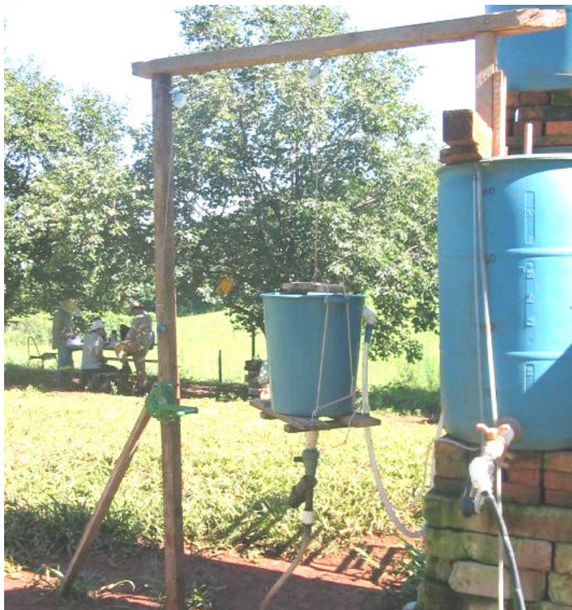
Figura 3 - Recipiente para controle da carga hidráulica.
