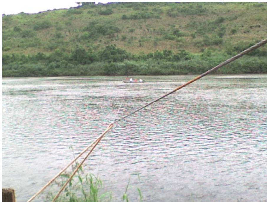
Figura 5 - Detalhe do cabo de aço graduado sobre toda a extensão do rio.
