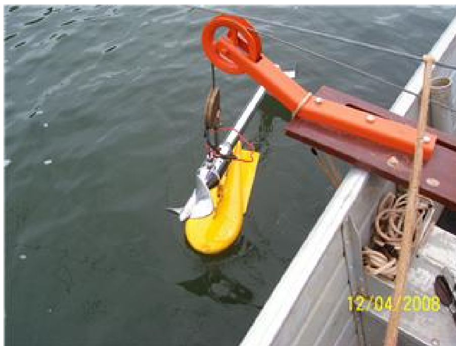
Figura 3 - Molinete hidrométrico MLN-07 acoplado ao lastro e guincho, para medição de vazão (Laboratório de Hidrossedimentologia).
