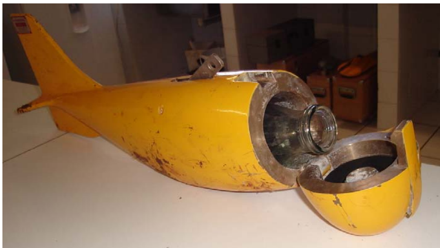
Figura 8 - Amostrador utilizado para coleta de sedimentos em suspensão USD – 49 com detalhe da garrafa de coleta da mistura água/sedimento (Laboratório de Hidrossedimentologia).
