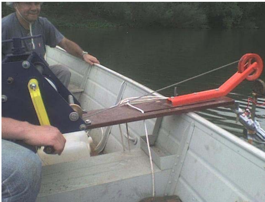
Figura 4 - Guincho hidrométrico com molinete hidrométrico acoplado (Laboratório de hidrossedimentologia).
