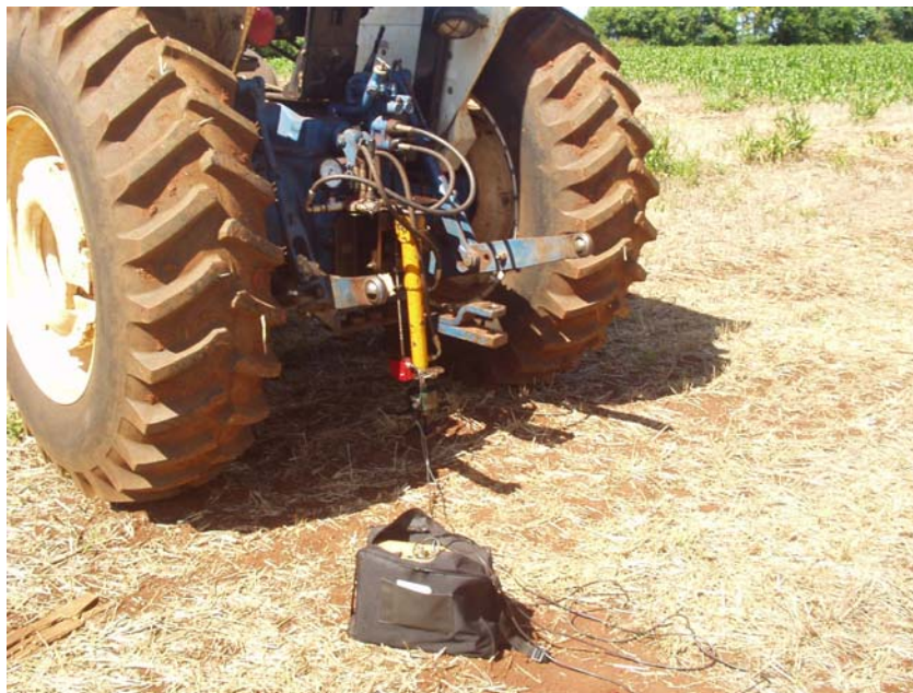
Figura 4 - Penetrômetro de placa acoplado a um trator agrícola.
